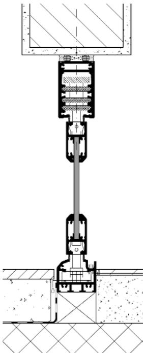
Durch die starkwandige obere Laufschiene ist das einseitige Parken einer Vielzahl von Flügeln möglich. Option: Höhenausgleichsprofil lieferbar. Untere Schiene kann in den Boden eingelassen werden – keine Stolperschwelle.
