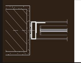
Seitlicher Wandanschluss mit Rahmen und Wetterschutzwinkel
